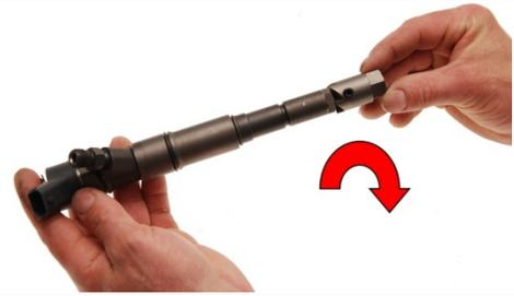
3. Inserte la fresa (1) en el hueco del inyector y limpie la superficie de sellado de la culata girando la fresa en el sentido de las agujas del reloj.
