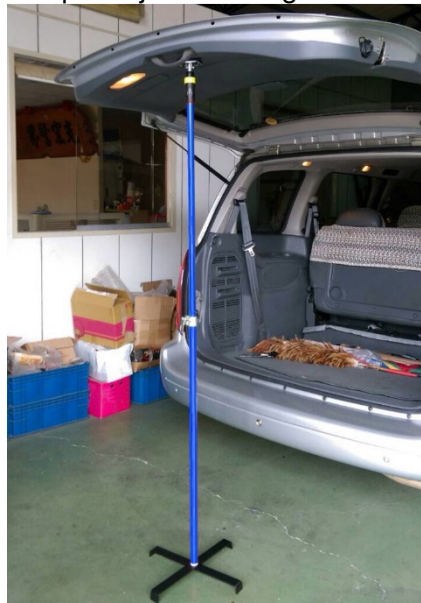
Klemme öffnen - Höhe einstellen – Klemme schließen Open the clamp - Adjust the height – Close the clamp
