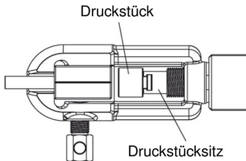
6. Hebel am Hydraulikzylinder solange betätigen, bis die Druckstückkante an den Klemmbacken anliegt.
