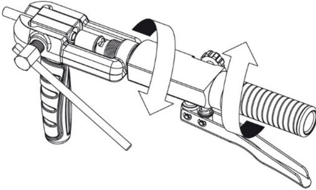
10. Hydraulikhebel betätigen bis die Druckstückkante an den Klammbacken anliegt.
