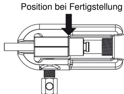
7. Entlastungsventil öffnen, Kolben vollständig zurück drücken, Ventil wieder fest verschließen und OP0 Druckstück entfernen.
