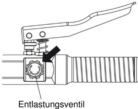
12. Werkzeug am Griff festhalten und Hydraulikzylinder, zum Entfernen des Druckstücks, gegen den Uhrzeigersinn herausdrehen.
