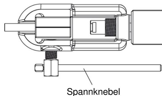
9. Hydraulikzylinder 3 Umdrehungen, zum Einsetzen des erforderlichen Druckstücks, gegen den Uhrzeigersinn drehen. Anschließend wieder im Uhrzeigersinn bis zum Anschlag drehen.
