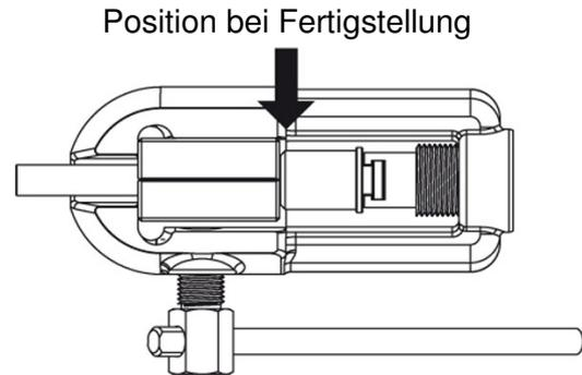
11. Entlastungsventil 1/2 Umdrehung öffnen und danach wieder verschließen.
