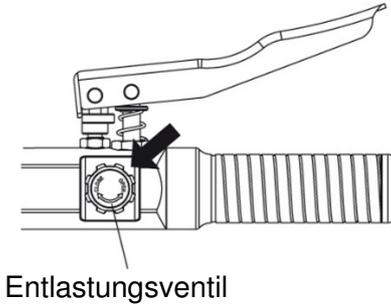
4. Griff installieren, Halter am Griff festhalten und Hydraulikzylinder bis zum Anschlag in den Halter drehen.
