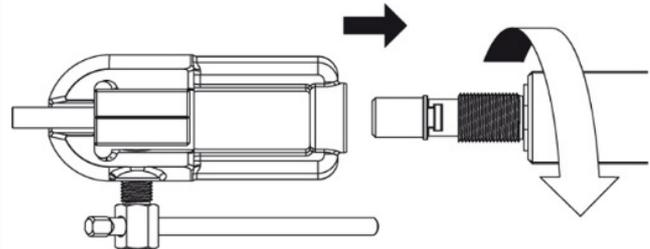
13. Befestigungsschraube mit Spannknebel lösen, Klammbacken und Leitung entfernen. Die gebördelte Leitung sollte dem jeweiligen Bördelungstyp entsprechen (siehe Abbildung unten).
